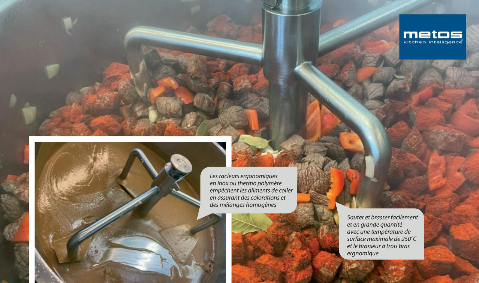
*Les racleurs ergonomiques en inox ou thermo polymère empêchent les aliments de coller en assurant des colorations et des mélanges homogènes*
