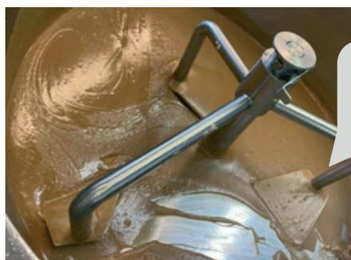
Les racleurs ergonomiques en inox ou thermo polymère empêchent les aliments de coller en assurant des colorations et des mélanges homogènes
