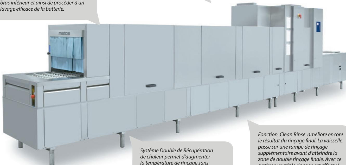
Système Double de Récupération de chaleur permet d'augmenter la température de rinçage sans augmenter la puissance électrique de la machine et de condenser, dans le même temps, les buées de la machine naturellement.
