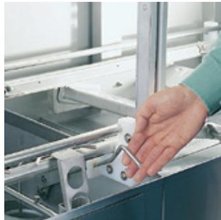
Toutes les cuves se vident par la manipulation d'un seul levier. Toutes les bondes et la surverse se ferment automatiquement quand la porte de la section rinçage est fermée.
