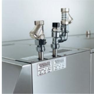
La façade arrière est lisse et d'un seul bloc. Tous raccords d'eau s'effectuent par le dessus de la machine. Les opérations d'entretien s'effectuent par la façade avant. La machine peut presque être installée contre un mur.
