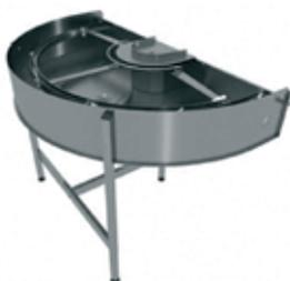
Les virages mécanisés sont actives par l'avancement de la machine. Ils sont entièrement en inox et les taquets d'avancement sont en téflon pour éviter toute friction. Ils sont de faible encombrement 790x790x905 pour le 90° et 790x1340x905 pour le 180°. Les virages mécanisées ne sont compatibles qu'avec les WD 151-421 et la WD 11.
